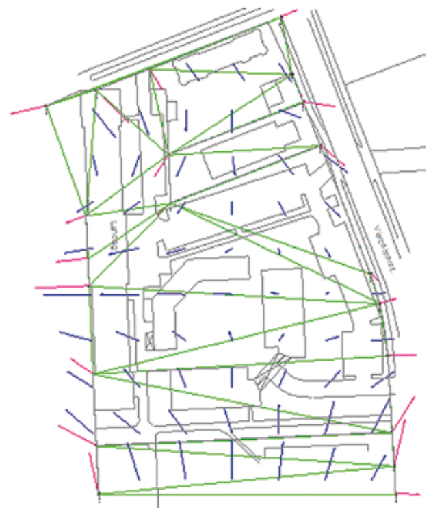
Helmert-Transformation mit Verteilung der Restklaffen
